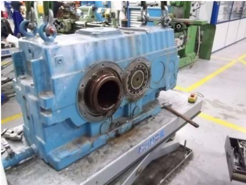
Vaciado del aceite lubricante y desmontaje de tapas de rodamientos
