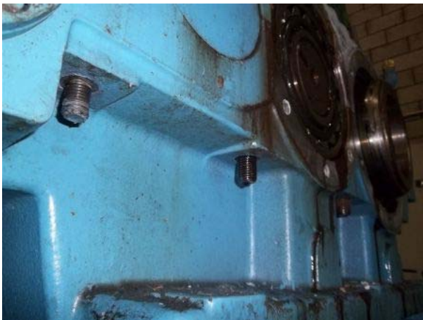
Detalle de los pernos roscados a la mitad superior. Las tuercas de fijación se han desmontado.
