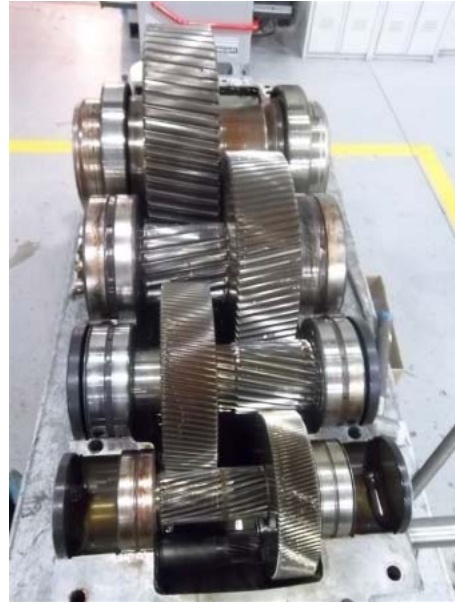
Observaremos la disposición de cada eje y las diferentes etapas de reducción
